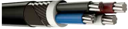
0,6/1 kV NAYFGbY, Çok Damarlı Enerji Kablosu, Alüminyum İletkenli, PVC İzoleli, Çelik Tel ve Bant Zırlıklı, PVC Kılıflı
