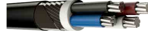
0,6/1 kV NAYFGbY, Çok Damarlı Enerji Kablosu, Alüminyum İletkenli, PVC İzoleli, Çelik Tel ve Bant Zırlıklı, PVC Kılıflı
