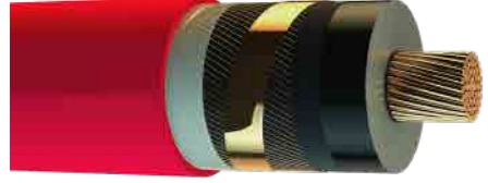
20,3/35 kV YXC7V-R, XLPE Yalıtkanlı, Bakır İletkenli, Orta Gerilim Enerji Kabloları
