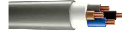
300/500 V NHXMH Çok Damarlı Enerji Kablosu, Bakır İletkenli, XLPE izoleli, HFFR Kılıflı
