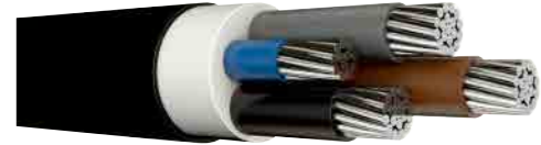
0,6/1 kV NA2XH, Tek veya Çok Damarlı Enerji Kablosu, Alüminyum İletkenli, XLPE izoleli, HFFR Kılıflı
