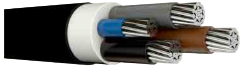
0,6/1 kV NA2XY (YAXV) Tek veya Çok Damarlı Enerji Kablosu, Alüminyum İletkenli, XLPE izoleli, PVC Kılıflı
